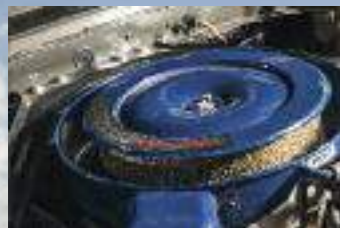
Sous le filtre, un carburateur Holley 4 corps 735 cfm.
